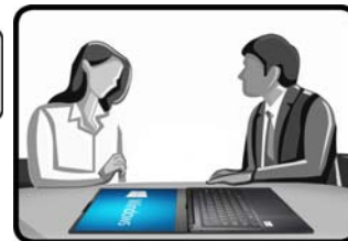
Abb. 4 - LCD-Bildschirm, der bei gedrehtem Bildschirm um 180 Grad geöffnet ist
