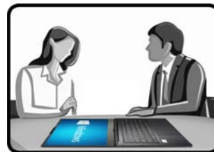
Figure 4 - Panneau LCD ouvert à 180 degrés avec écran pivoté
